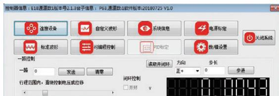
单路主界面：单点发送、清零、滑块控制、开闭环切换、电压或位移的下位机信息的自动显示。
