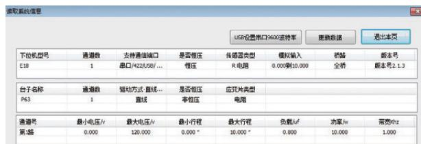
USB 设置串口 9600 波特率：表示在 usb 通信状态下，设置串口波特率为 9600 波特率，应用在下位机在不知波特率情况下或设置为 23400 波特率后再次设置为 9600 波特率，恢复为串口通信为：9600 波特率。
