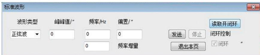
填写要发送的波形的峰峰值、频率、偏置以及要发送的波形（正弦、方波、锯齿、三角波、噪音波形待加入），单击发送，软件根据开闭环  闭环，来发送开环或者闭环波形数据给下位机，由下位机执行发送波形功能，同时发送按钮变暗，停止按钮亮起。发送一次发送波形功能，同时主界面的数据采集功能停止，只有波形停止、自定义波形停止、可编程控制发送完成、发送单点、清零、由滑块控制或步进单点促使停止波形发送（包括标准波形以及自定义波形），采集信息才恢复采集。
