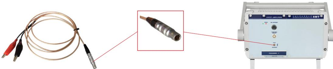
若您驱动的压电产品是裸线式的，无连接器，则可通过单芯 LEMO 线进行连接，LEMO 端与控制器的 OUTPUT 输出端相连，鱼夹端与压电产品的引线相连，红色鱼夹为正极。
