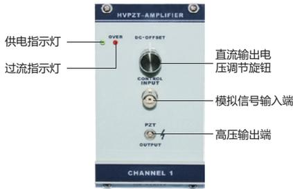
**E09.S3 PZT 传感控制模块 × 1:** 该模块是给各类 PZT 或微动工作台等纳米定位机构中的传感器提供高精度、高稳定性和高可靠性的激励信号，并检测和处理 PZT 或微动工作台等纳米定位机构中的传感器信号，并将该传感器信号通过内部的算法电路完成伺服控制。
