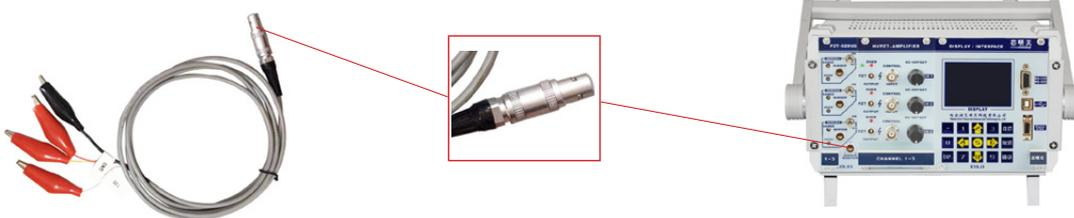
将传感输出线的 LEMO 端连接到控制器的传感监控接口 (sensor monitor)，鱼夹端与电压显示设备（如示波器、万用表等）相连，红色鱼夹为正极，标号 CH1、CH2、CH3 依次为 1、2、3 通道。
