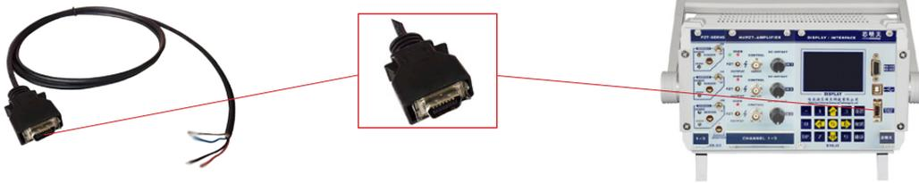
将 I/O 线的连接器插入控制器的 Digital In/Out 接口。根据需要作为输入或输出模式，作为输入时，裸线端连接模拟信号源（0 或 3.3V）；作为输出时，裸线端连接电压显示设备（如示波器、万用表等）。
