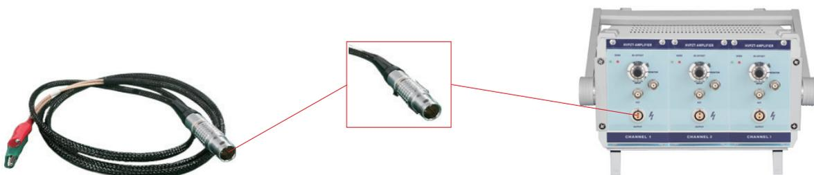
双芯航插端与控制器的 OUTPUT 输出端相连，鱼夹端与压电产品的引线相连，红色鱼夹为正极。
