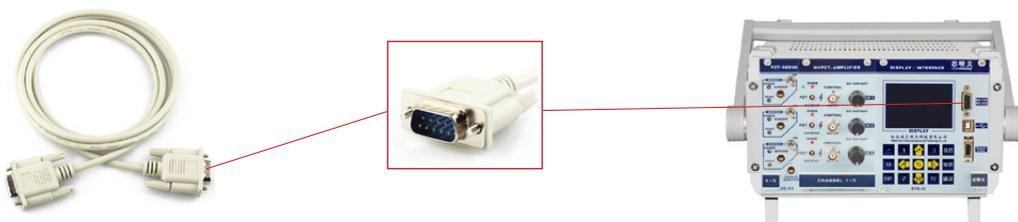
将串口线的针端插入控制器的 RS-232/422 接口, 另一端插入计算机的对应接口。
