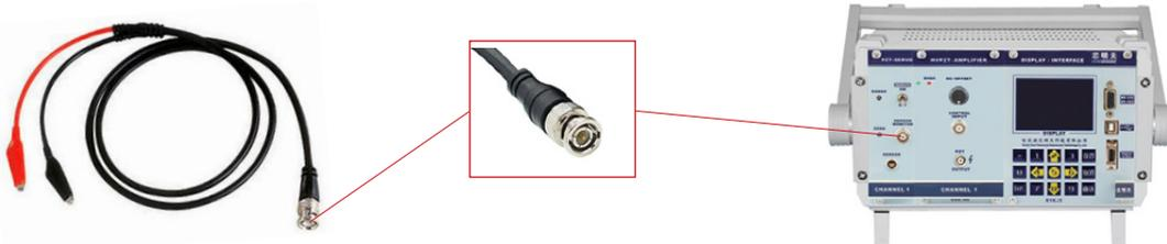
将 BNC 转鱼夹线的 BNC 端传感监控接口 (sensor monitor)，鱼夹端与电压显示设备（如示波器、万用表等）相连，红色鱼夹为正极。用于监测传感的输出信号，按需连接，可不连接。
