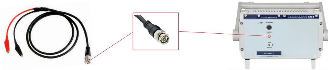
将 BNC 转鱼夹线的 BNC 端连接到控制器的控制模拟输入插孔，鱼夹端与外部信号源（如信号发生器、DA 卡等）相连，红色鱼夹为正极。
