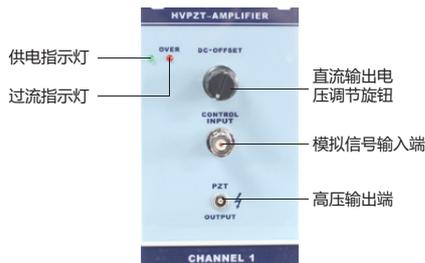
**E09.S1 PZT 传感控制模块 × 1:** 该模块是给各类 PZT 或微动工作台等纳米定位机构中的传感器提供高精度、高稳定性和高可靠性的激励信号，并检测和处理 PZT 或微动工作台等纳米定位机构中的传感器信号，并将该传感器信号通过内部的算法电路完成伺服控制。
