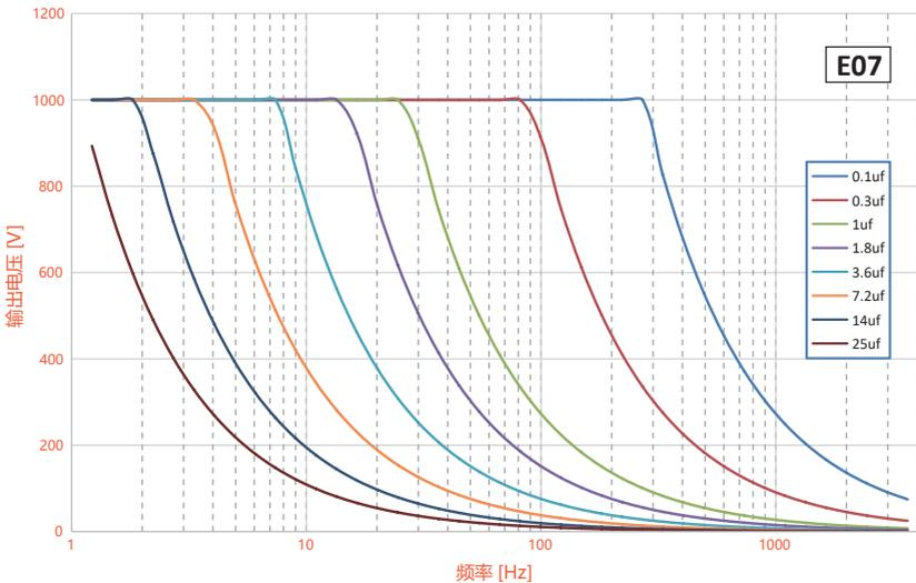
图 14.E07 系列负载 - 电压 - 频率曲线图
