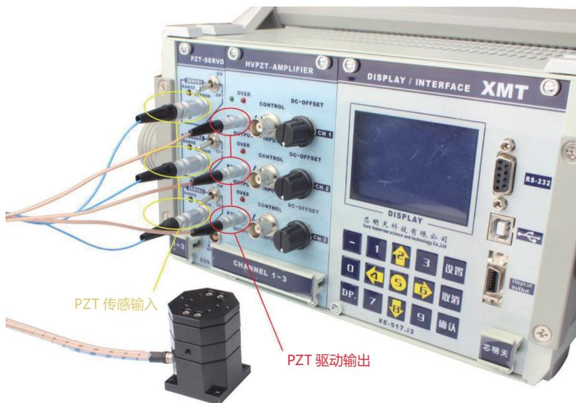
图 21.E01 系统 (含 E18/E09/E03 模块) 配 芯明天 P63 纳米定位台 连接示意图
