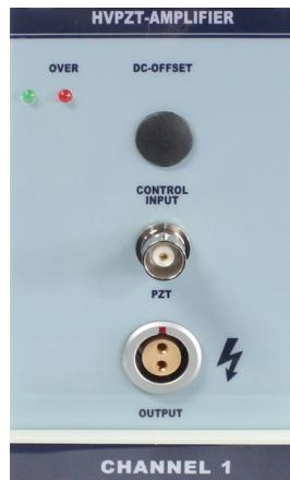
图 17. 双极性组合式双电极功率放大模块
