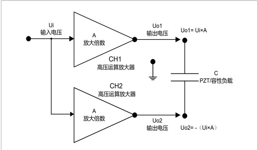
图 15. 组合式双电极压电陶瓷控制器原理框图
