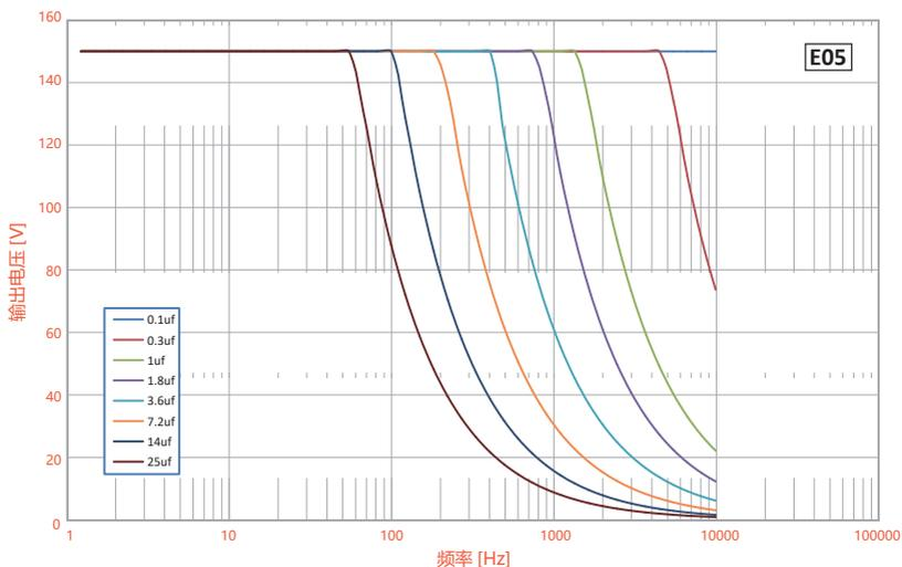
图 9.E05.00 负载 - 电压 - 频率曲线图
