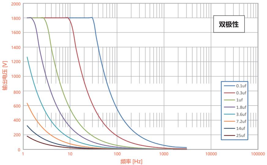
图 18. 双极性负载 - 电压 - 频率曲线图
