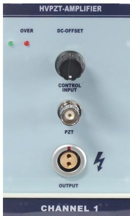
图 16. 单极性组合式双电极功率放大模块
