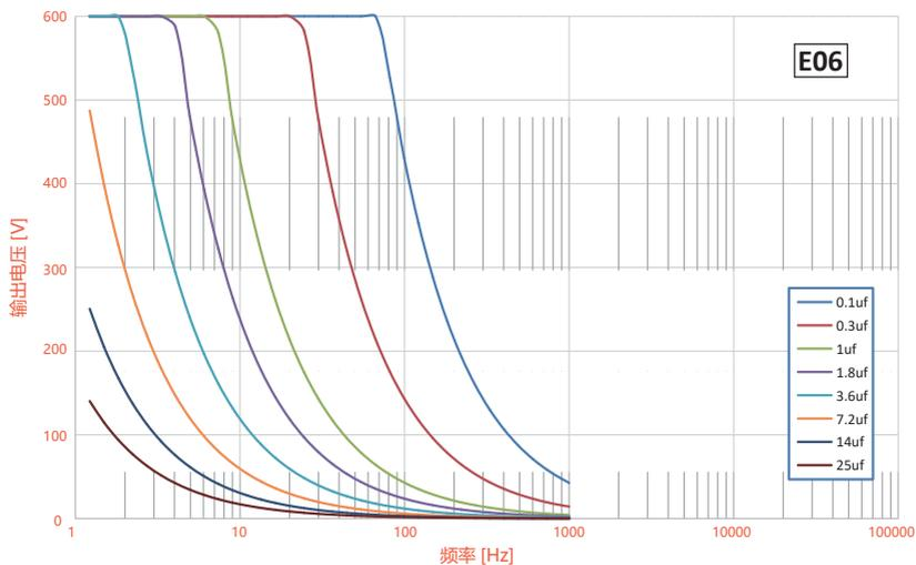
图 12.E06.00 负载 - 电压 - 频率曲线图
