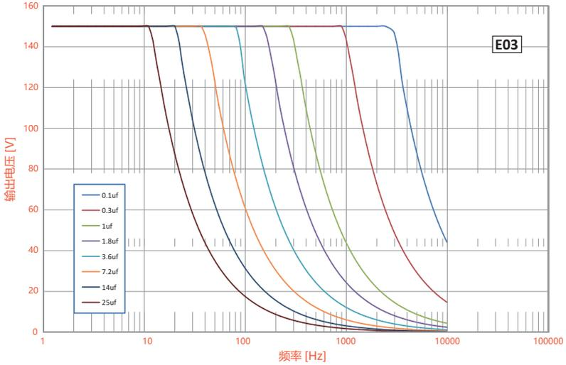
图 6.E03 系列负载 - 电压 - 频率曲线图
